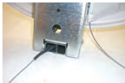
Heizleiter zur Beheizung des Empfängerarms
